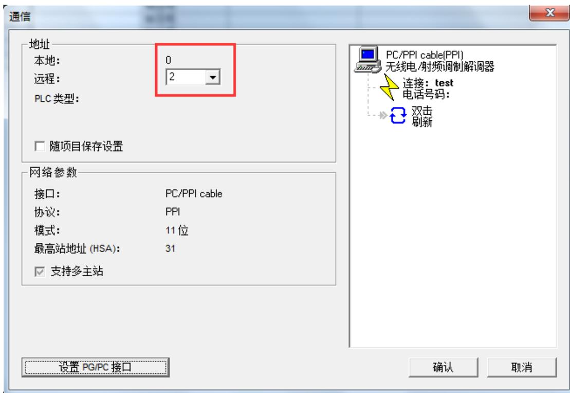
6、搜索到 PLC 之后，可能显示 PLC 的 CPU 型号，也可能显示 unknown，两者都可以通讯。
