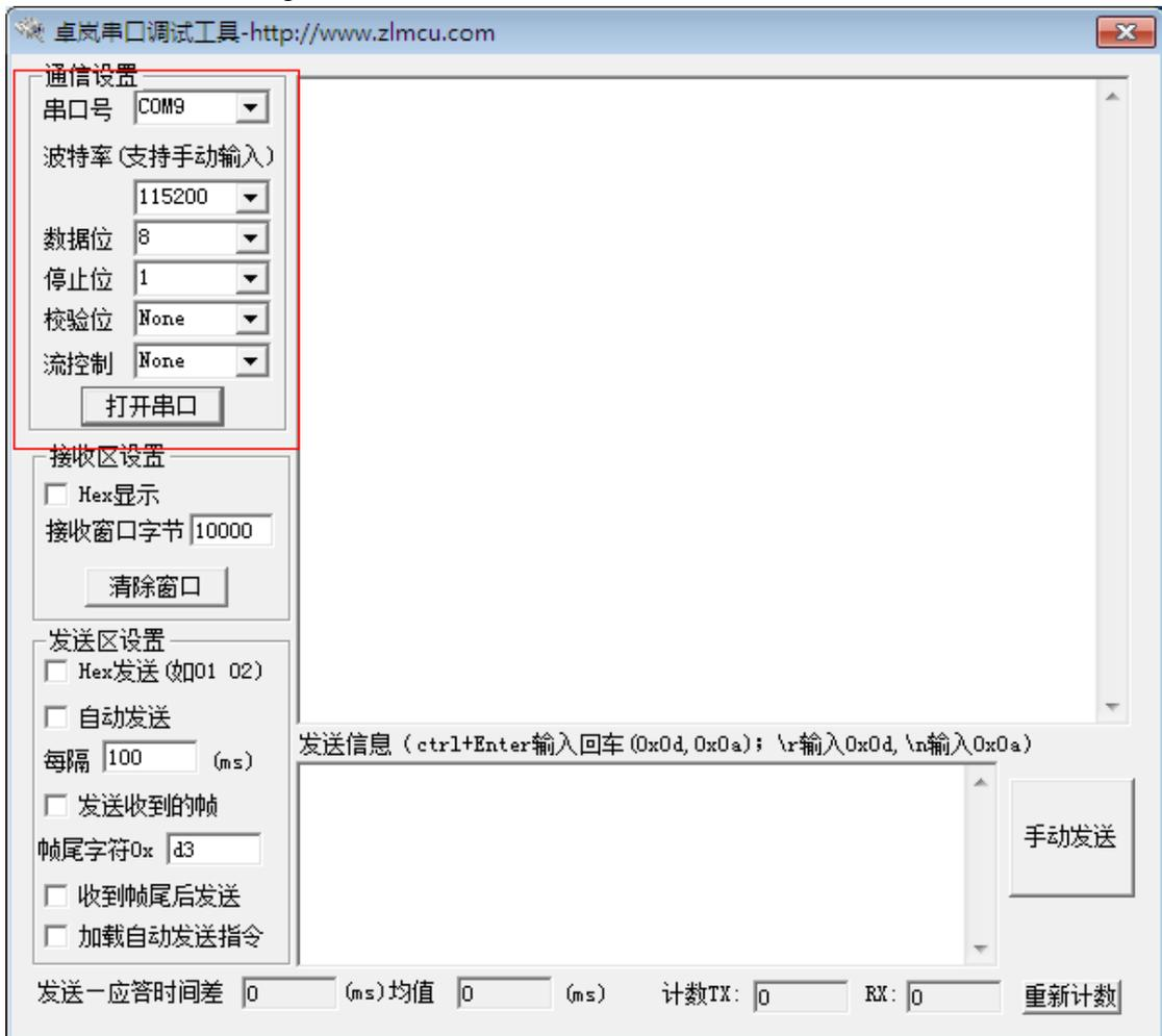
对软件做如上配置，串口号请在电脑的设备管理里面查看。这个配置与串口服务器的串口参数要保持一致，否则数据就可能乱码。点击“打开串口”按钮，如果成功则不会有提示，否则会弹出打开串口失败对话框。
