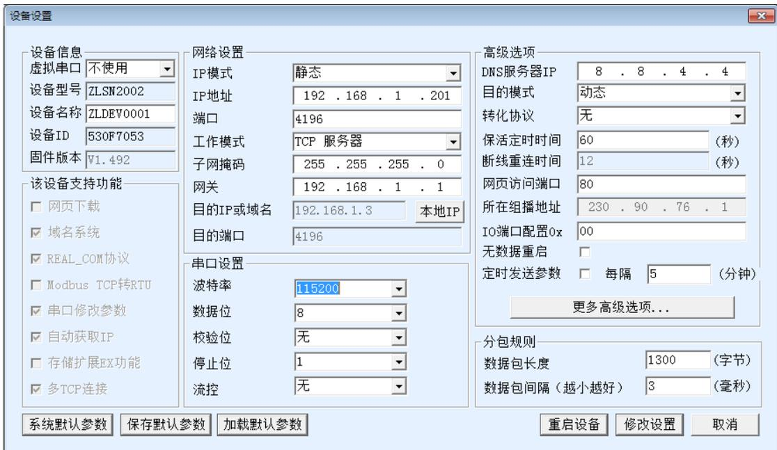
可以看到模块的具体参数，在这里作者的串口服务器工作在“TCP 服务器”模式，IP 地址为 192.168.1.201，端口号为 4196（用户可以根据自己的网络环境来进行相应的更改）。波特率为 115200,8,无,1,无。设置完成后点击右下角的”修改设置”按钮，模块会保存配置并重新启动，再次搜索就可以看到配置已经更改。
