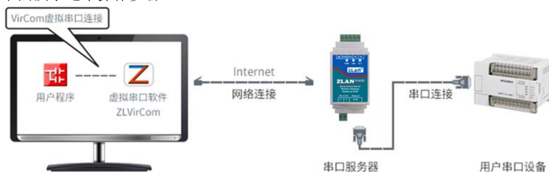
图 18 虚拟串口的作用
