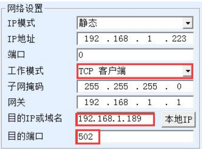
图 23 Modbus TCP 做客户端
