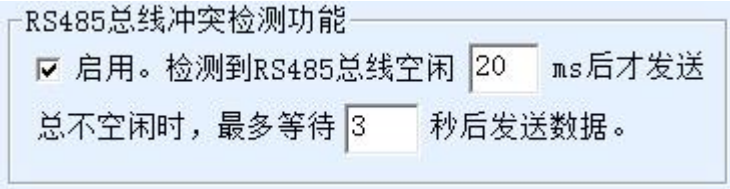
图 46 RS485 防冲突空闲时间
