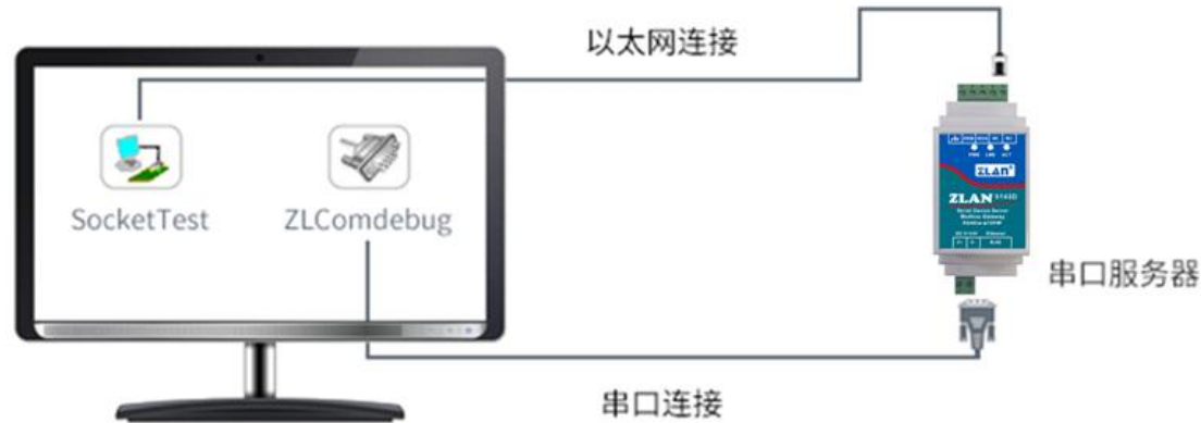
图 15 TCP 通讯示意图
