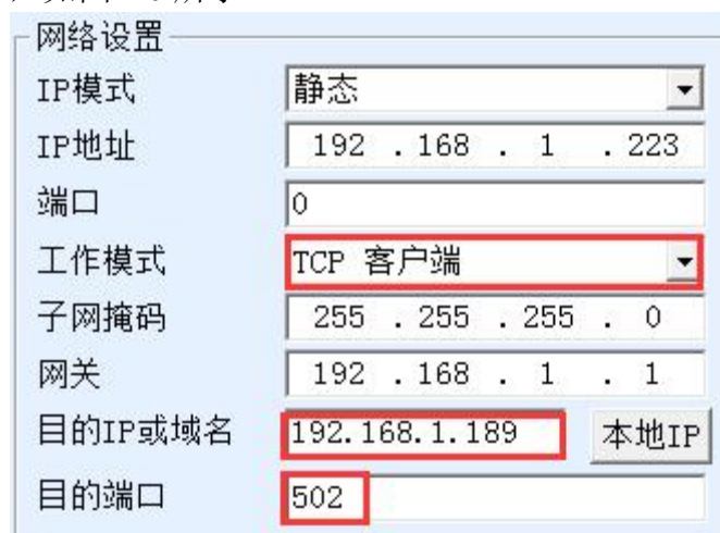
图 20 Modbus TCP 做客户端。
