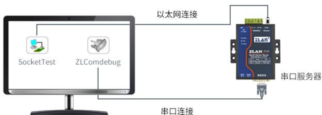
图 12 TCP 通讯示意图
