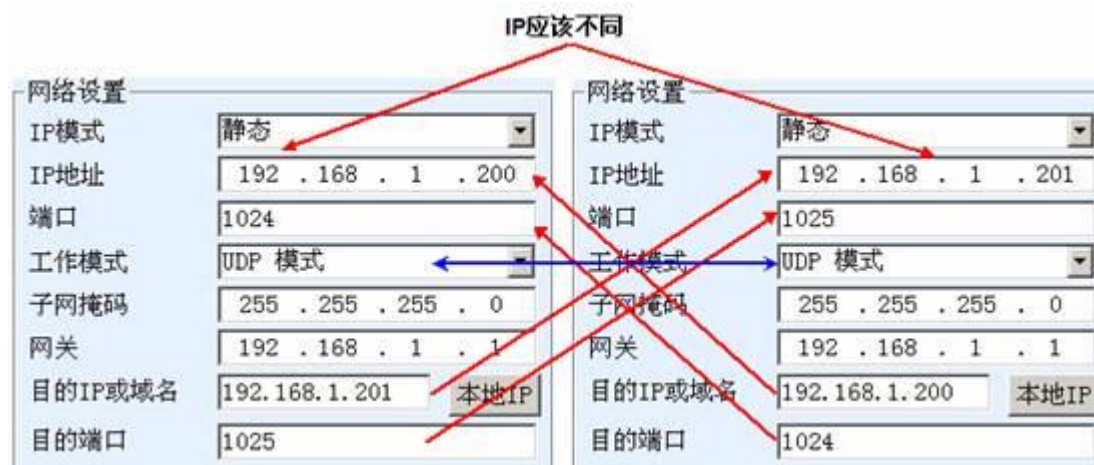
图 26 UDP 设备对联参数配置
