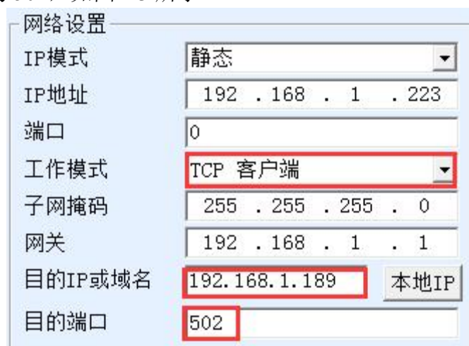
图 23 Modbus TCP 做客户端。
