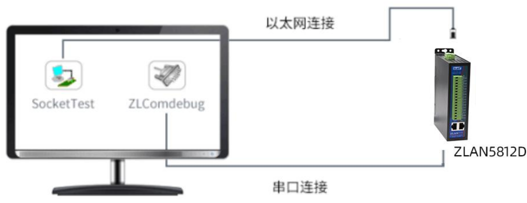
图 15 TCP 通讯示意图
