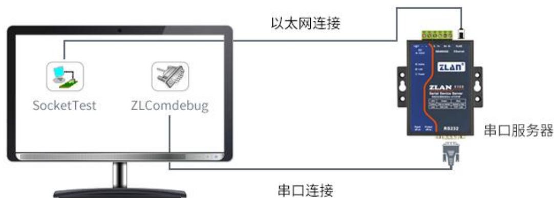
图 11 TCP 通讯示意图
