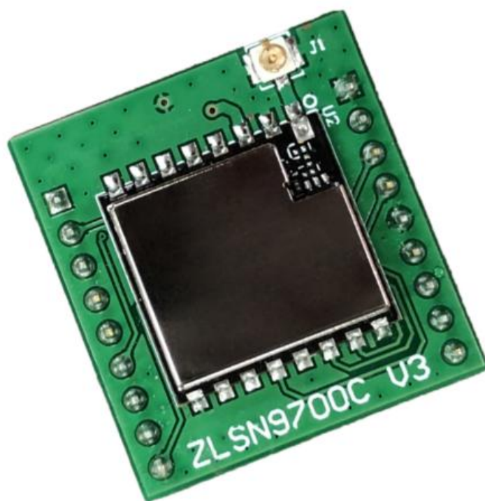
图 1 ZLSN9700C LoRa 转串口正面
